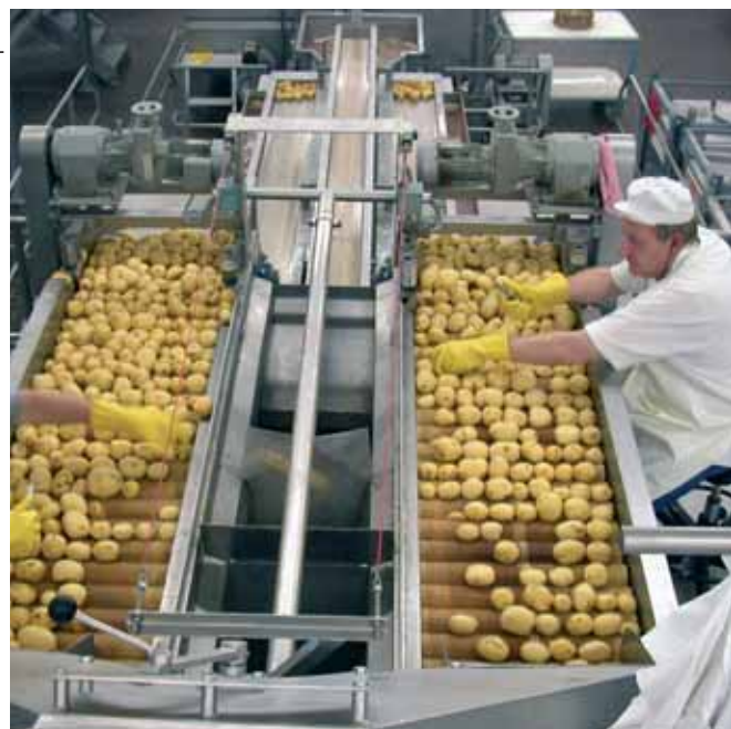
La pomme de terre est toujours plus une matière première industrielle. Ici, une installation de triage de l'entreprise Zweifel.
