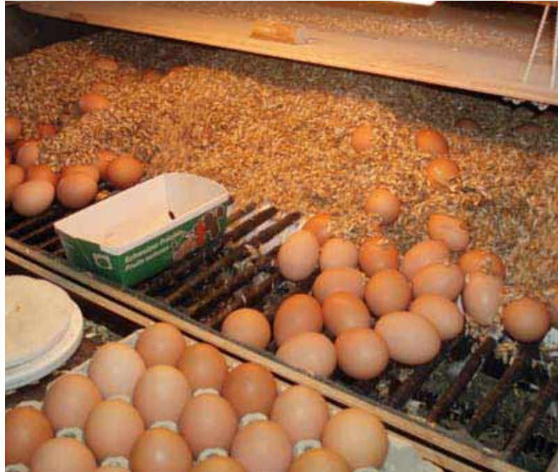
Un tapis roulant amène les œufs et la litière sur une grille à travers laquelle la litière coule/tombe vers le bas.
