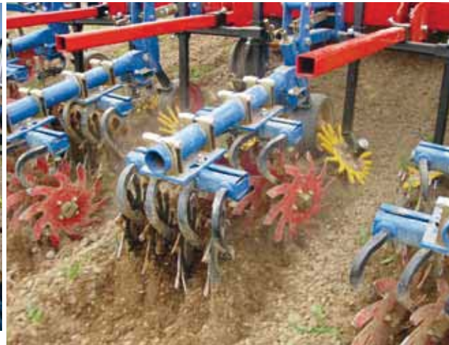
Lors du débutage, la sarcluse étoile peut être combinée avec une sarcluse à doigts.
