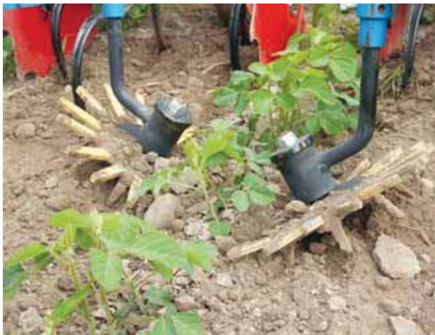
La sarceuse à doigts arrache les mauvaises herbes même sur la ligne (distribution: Fobro-Kress, Hüswil, ou Althaus AG, Ersingen).
