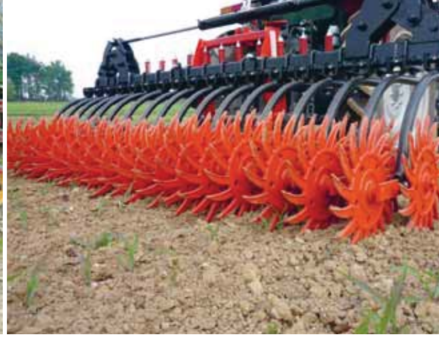
La houe rotative doit rouler vite (min. 8 à 12 km/h) et possède une grande capacité de travail (Moro; distribution: GVS-Fried AG, Koblenz).
