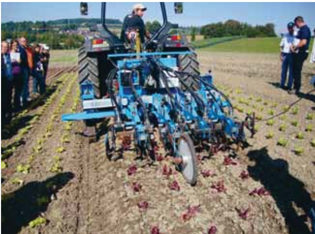
La sarcluse sélective (seulement pour les salades, env. 60'000 euros) remplace le travail manuel sur les lignes. Identification informatisée des plantes. (Robovator; distribution: Fobro-Kress).
