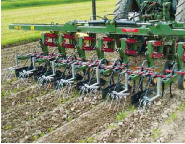
Sarcluse à socs autopilotée par caméra (Thyregod; distribution: Daniel Wyss Landtechnik, Ruppoldsriet).
