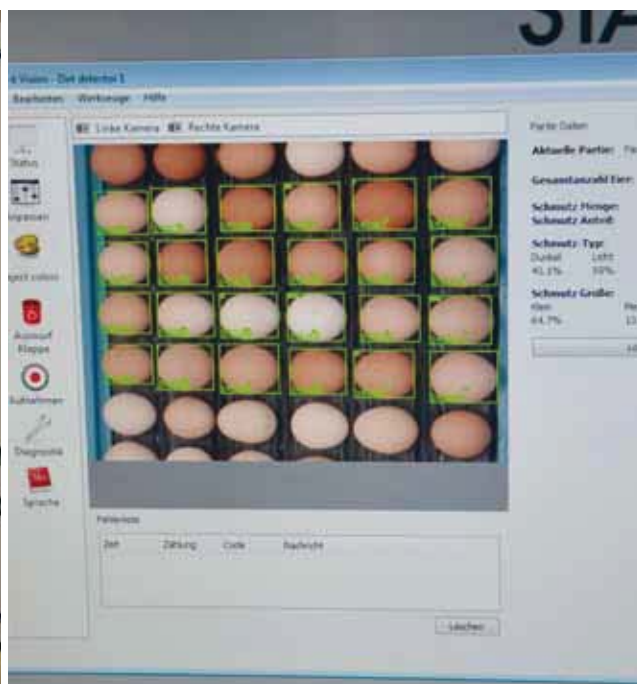
L'installation permet de séparer les œufs bruns des œufs blancs, et le scanner ne laisse passer que les œufs qui sont vraiment propres.
