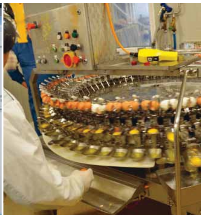
Les œufs pour l'industrie passent dans une casserole automatique qui permet de fabriquer des ovoproduits liquides.
