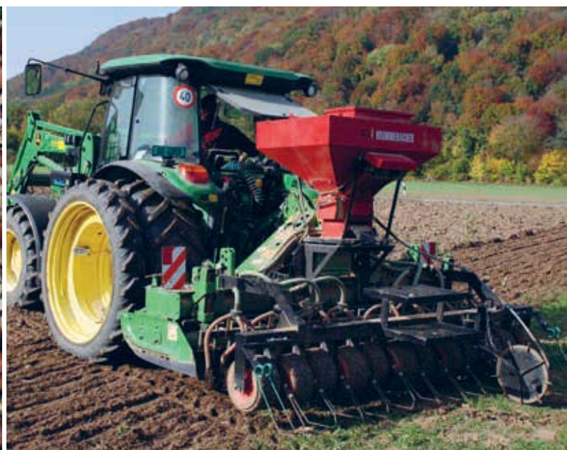
Le semoir universel de Krummenacher va très bien pour semer tous les mélanges de graines, et ces derniers ne se démangent pas dans le réservoir.
