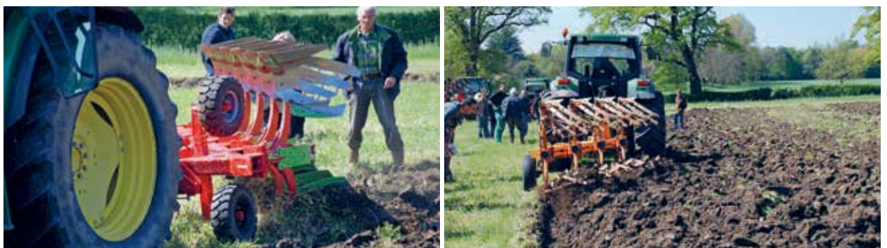
Une charrue pour un labour superficiel de la marque espagnole Escudero (à gauche) et une charrue classique travaillant à profondeur réduite grâce une béquille à roue.
