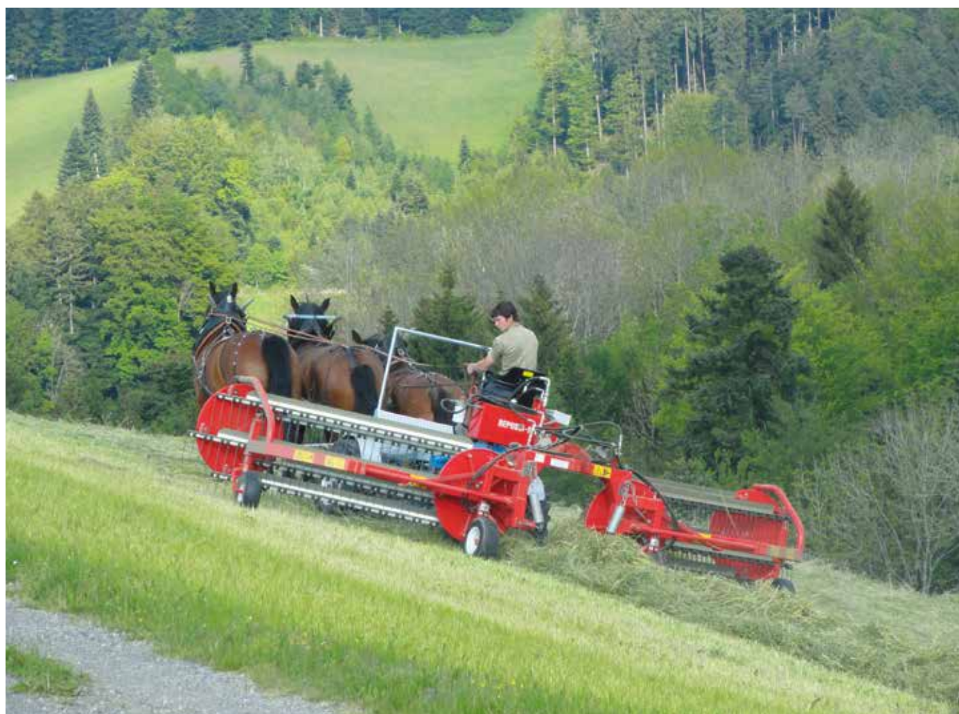
David Michel avec son andaineur: La machine est entraînée par les roues de l'avant-train qui actionnent une pompe hydraulique.
