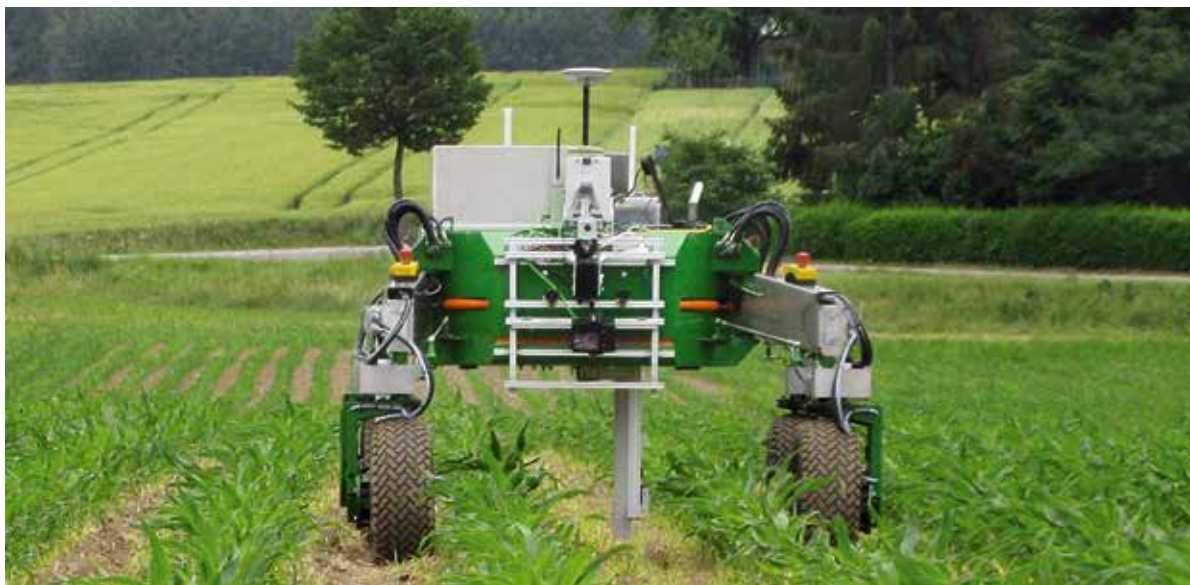
Le Bonirob développé par les sociétés Bosch et Amazone devrait un jour arriver à enfoncer les mauvaises herbes dans la terre avec une vis, mais il est encore loin d'être au point. Photo: Amazone
