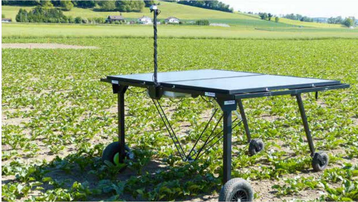
Le robot désherbeur solaire d'ecoRobotix et son pulvérisateur d'herbicide à l'œuvre dans un champ de betterave. Photo: ecoRobotix
