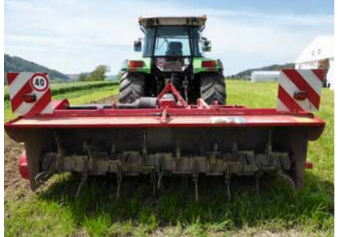
Essai de destruction de prairie à l'aide d'un déchaumeur à rotor. Photo: Jo-Anne Perret.
