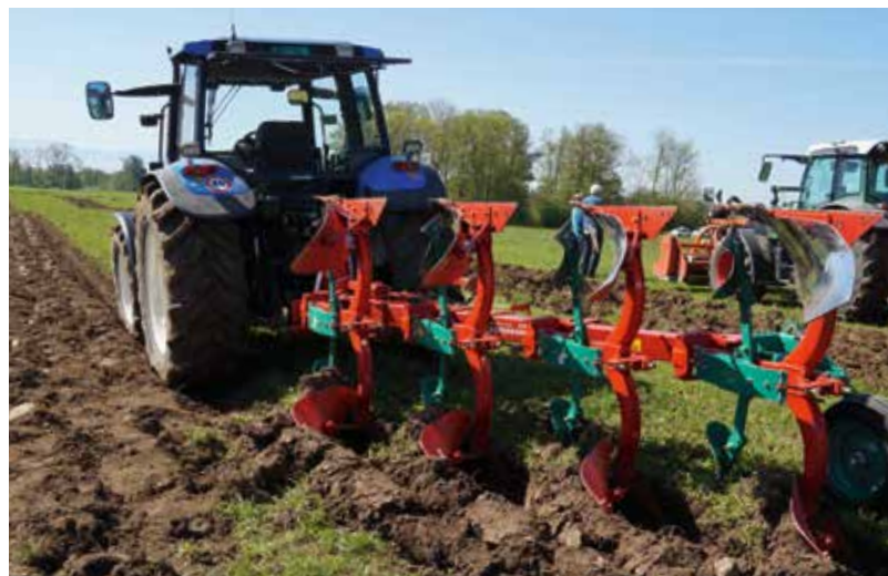
Il est possible de labourer superficiellement avec une charrue conventionnelle bien réglée. Photos: Thomas Alföldi
