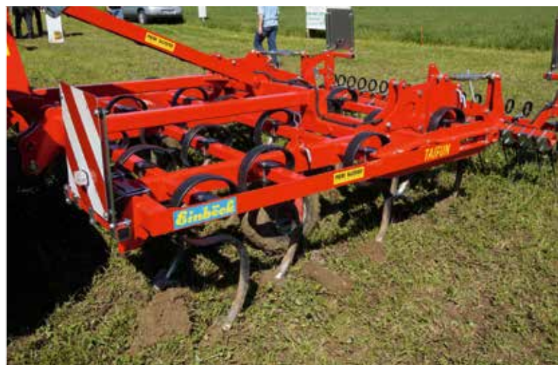
Les cinq rangées de dents du vibro-déchaumeur «Taifun» (constructeur: Einböck) effectuent un bon travail d'émottage.
