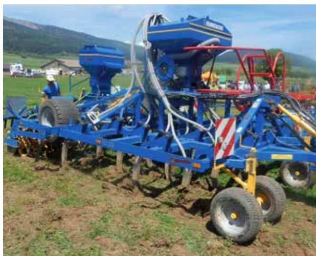
Les roues de jauge à l'avant et l'essieu arrière du Treffler TG 300 lui confèrent une grande précision dans la profondeur de travail.
