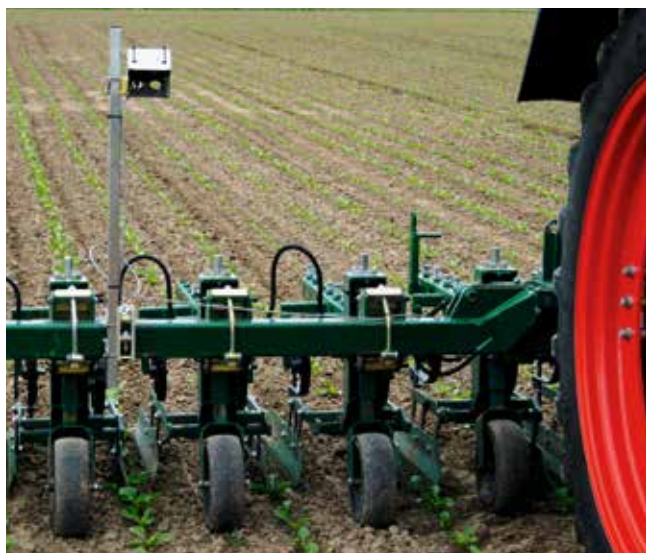
Les sarcleuses guidées par caméra ont une grande flexibilité d'utilisation. Photo: Garford.com
