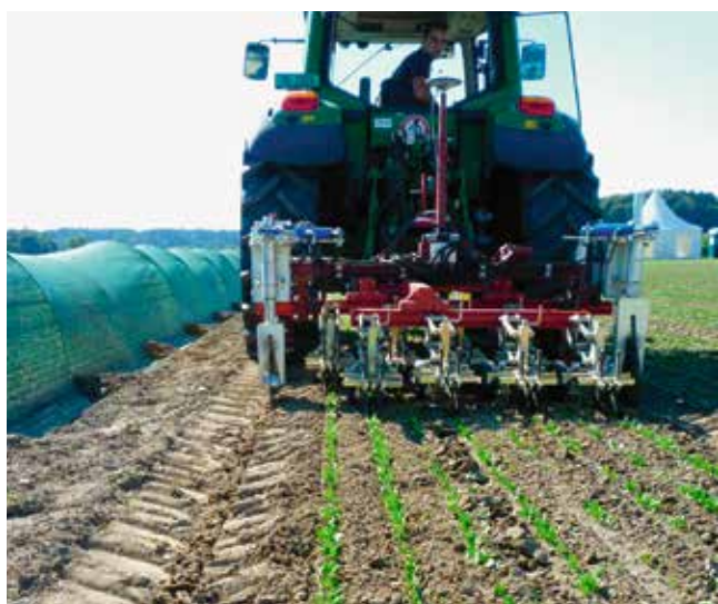
Système par satellite: les disques permettent de guider la machine. Photo: Lenzberg.ch
