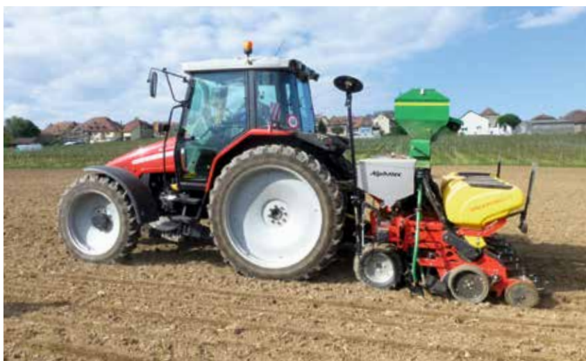
Ce prototype a été développé pour la culture du soja par Maurice Clerc, FiBL, puis construit par la société Alphatec. Le semis de couverture peut être fait avec précision en combinant un semoir de précision pour le soja et un semoir en ligne pour le semis de couverture. Photos: Maurice Clerc
