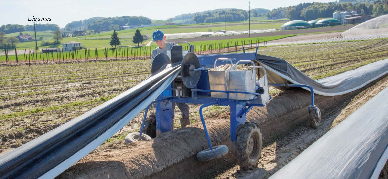
Électrique, l'«araignée à asperges» soulève la bâche et libère la butte pour ramasser les asperges blanches. Photos: David Eppenberger
