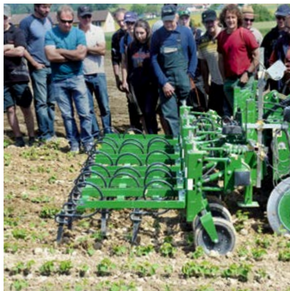
Le Garford Robocrop piloté par caméra couleur. Photo: hir
