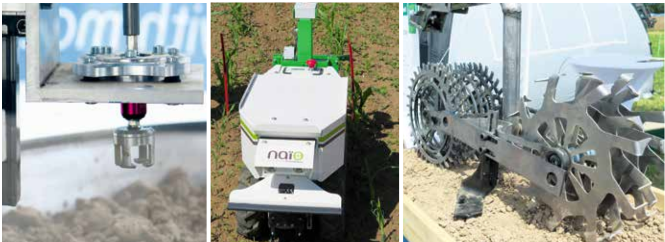
De g. à dr.: Le robot Unirob a 2 fraises qui désherbent 2 lignes (3 ha en 16 h). Le Z440 de Naïo Technologies désherbe – et peut porter p. ex. une caisse de tomates lors de la récolte. Pour sarcler plus près de la ligne, une sarceuse qui ne dévie pratiquement pas latéralement. Photos: Katharina Scheuner
