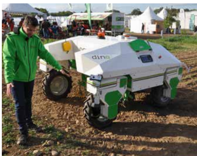
Le prototype «Dino» pèse 400 kg et travaille à une vitesse de 3 à 4 km/h.
