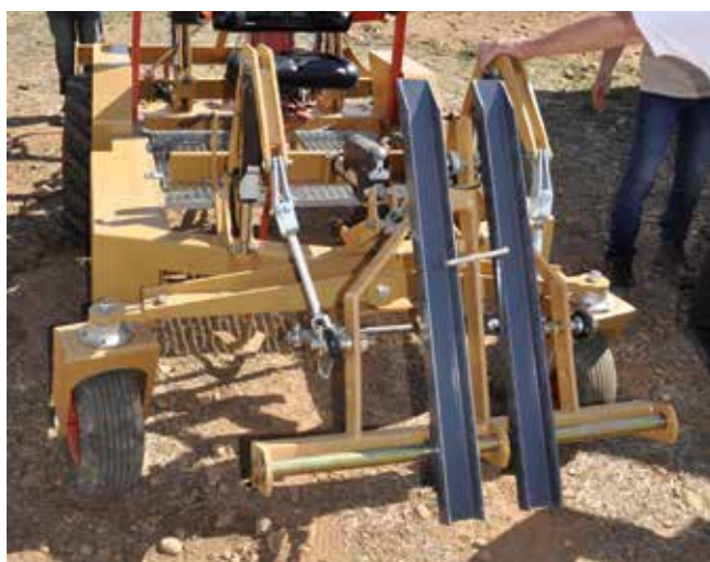
Tracteur électrique d'une puissance de 25 ch. pour un poids de 450 kg.
