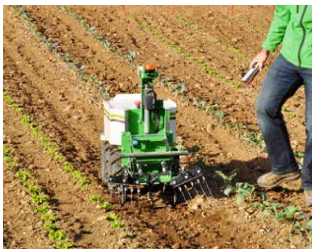
Le modèle «Oz», avec ses 150 kg, travaille à 1.3 km/h. Photos: C. Hirschi
