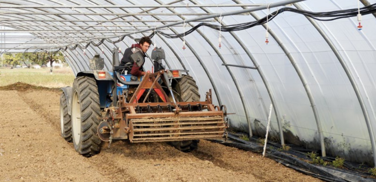
Avec la technique des planches permanentes, les passages de roues restent fixes. Pour le travail des buttes, on utilise des outils à dents et à disques non disponibles dans le commerce. Photos: Christian Hirschi
