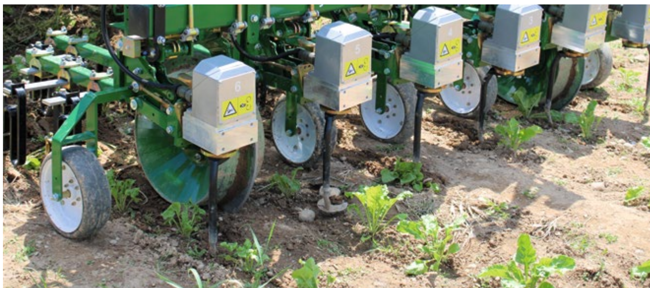
Grâce à sa technique d'analyse vidéo des plantes, la sarcluse Garford Robocrop InRow permet de sarcler les betteraves sur la ligne. Photo: hir
