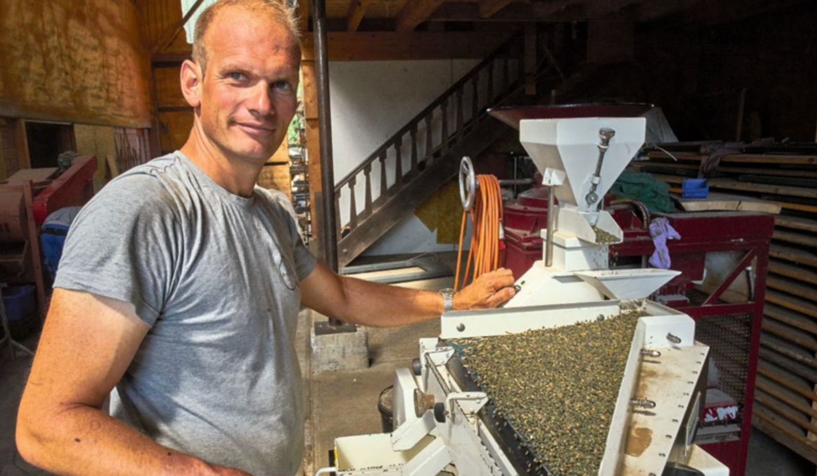
Stefan Brunner sèche et nettoie des grandes cultures spéciales dans sa ferme. Le trieur à gravité permet une deuxième étape de nettoyage.
