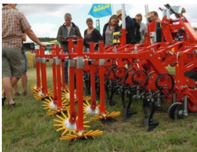
Une des innovations présentées: La sarclouse à assiettes Chopstar Twin a été développée pour le sarclage dans les cultures sur mulch. Photo: Claudia Frick
