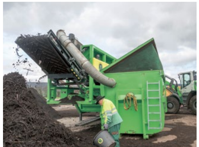
Le séparateur pneumatique enlève les morceaux de plastique qui sont restés dans le compost et les envoie dans un container.
