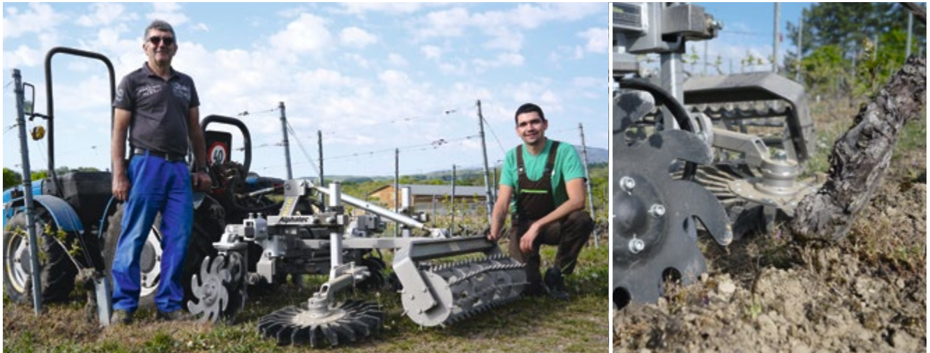
La bineuse Bähr de Philippe (à g.) et Franck Nicole est conçue pour nettoyer efficacement les pieds de vigne ainsi que la végétation du rang.
