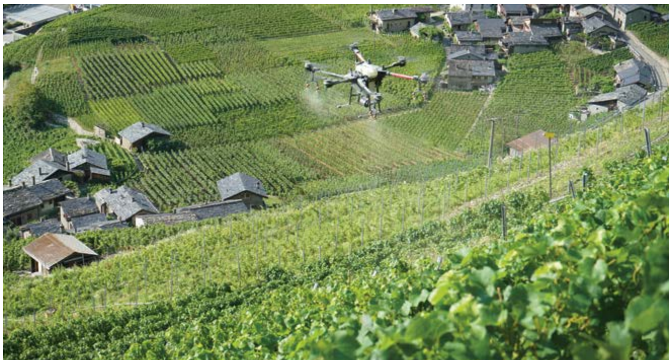
Équipé d'une cuve d'une capacité de 16 litres, le drone des Besse est capable de traiter plus de 1000 mètres carrés en quatre minutes.
