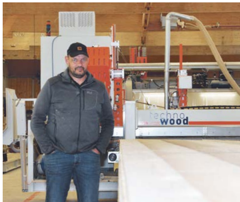
Jürg Hirschi devant sa ligne de production capable de cheviller des plaques de contreplaqué faisant jusqu'à 24 cm d'épaisseur. Photo: Stephan Jaun
