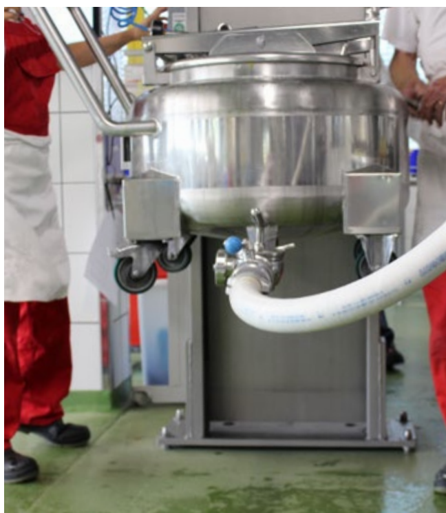
La confiture passe par un tuyau pour aller dans l'installation d'emportage.
