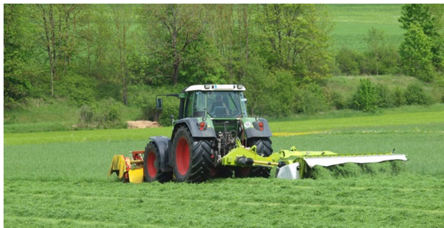
La faucheuse-conditionneuse peut améliorer le fourrage mais aussi tuer des petits animaux.
