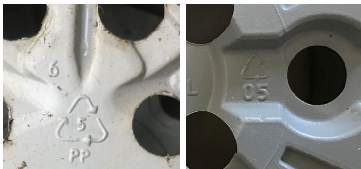
La plupart des pots sont en polypropylène (PP), comme l'indique le code de recyclage gravé sur le fond du pot. Presque toutes les plaques sont en polystyrène (PS).
