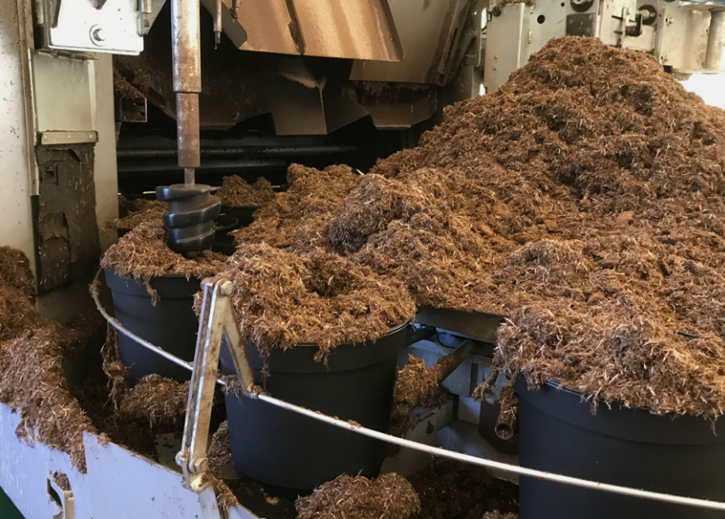
Remplissage mécanique de pots avec un substrat pour pépinières à teneur réduite en tourbe
