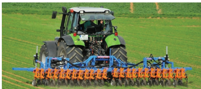
Fig. 2: Sarcleurs pilotés par des caméras individuelles pour le sarclage dans plusieurs écartements de semis. (Photo: Schmotzer)
