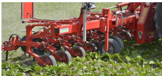
Fig. 1: La caméra détecte deux rangées de plantes et guide le châssis à déport latéral de manière dynamique. (Photo: Einböck GmbH)
