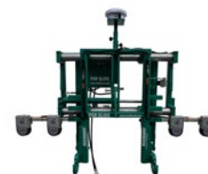
Fig. 4: Système de régulation par ultrasons, à gauche sur la sarcleuse, à droite sur le châssis à déport latéral. (Photo: Reichhardt)
