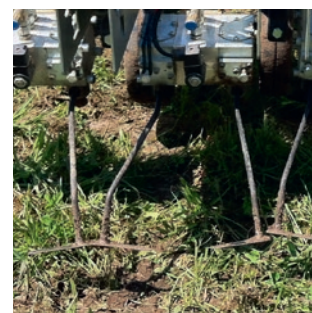
Fig. 3: Sarclage à l'intérieur des lignes. À gauche, le In-Row-Weeder de Garford, à droite le Robovator de Poulsen. (Photo à gauche: Garford, à droite: Poulsen)
