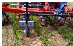
Fig. 4: Système de régulation par ultrasons, à gauche sur la sarcleuse, à droite sur le châssis à déport latéral. (Photo: Reichhardt)
