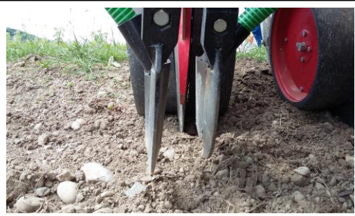
Semis de l'essai à Yens VD, le 23.05.2017, On voit les deux socs de semis du semoir Krummenacher, distants de 8 cm. On voit également que le sol est caillouteux.
