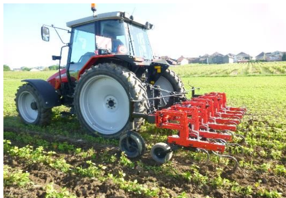
Premier sarclage à Yens le 24.06.2016 avec une sarceuse Maternacc . Seul un interligne de 28 à 30 cm de large est sarclé. Ainsi, les plantes compagnes à proximité de la ligne de soja ne sont pas détruites.
