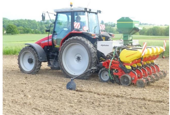
Le semoir à double trémie spécialement conçu par l'entreprise Alphatec pour les besoins de l'essai semé à Yens le 17.05.2016
