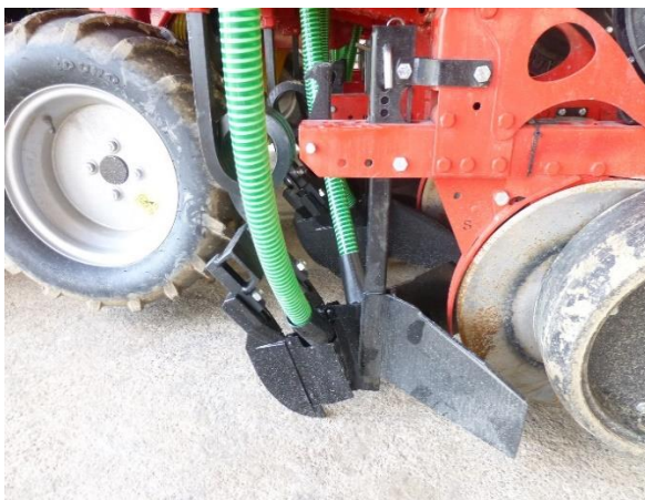
Le semoir à double trémie spécialement conçu par l'entreprise Alphatec pour les besoins de l'essai semé à Yens le 17.05.2016
