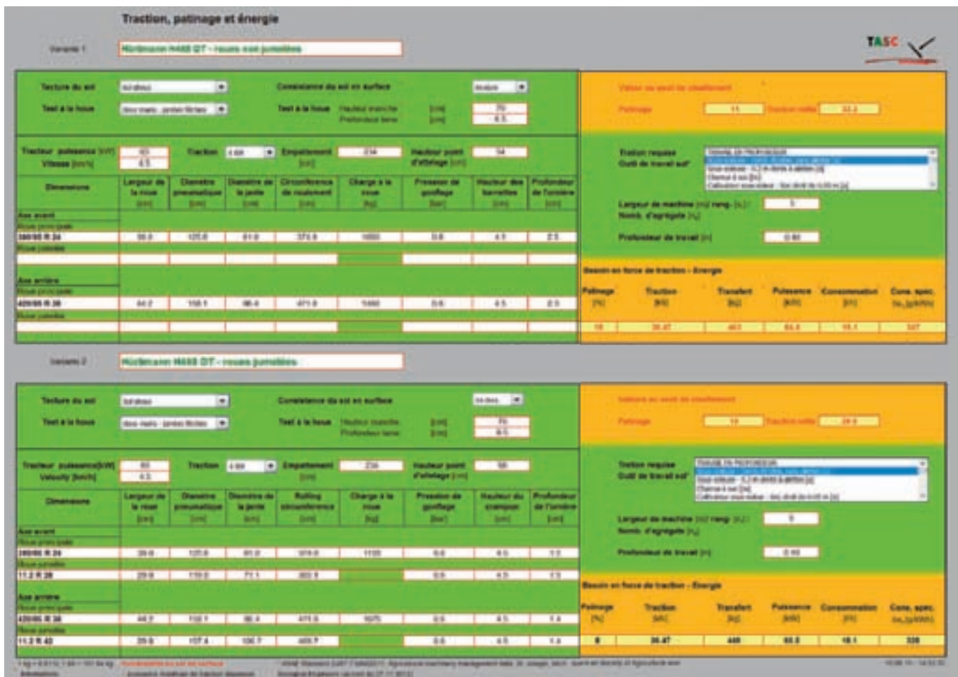
Fig. 6: Vulnérabilité du sol en surface suite au cisaillement, force de traction nécessaire avec indications correspondantes sur le patinage, le transfert de charge à la roue et la consommation d'énergie avec et sans roues jumelées.
