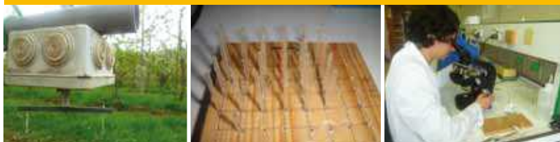
Fig. 5.3 : Capteurs de spores types ROTOROD placés dans le verger. Les barrettes engluées sont observées au microscope pour le comptage des spores après chaque pluie (3 répétitions/modalité).
